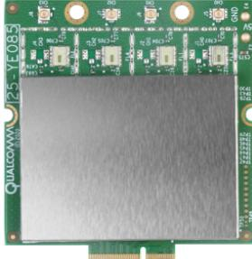
MX6974 F5 是一款采用 M.2 E-key 接口，支持 PCI Express 3.0 协议的嵌入式无线网卡。采用 Qualcomm® 802.11ax Wi-Fi 技术，支持 5180-5850GHz 频段，具备 AP 及 STA 功能，同时具备 4x4 MIMO 和 4 个空间流，适用于 5GHz IEEE802.11a/n/ac/ax 应用，相比上一代无线网卡的传输效率更高，并具备动态频率选择(DFS)功能。
